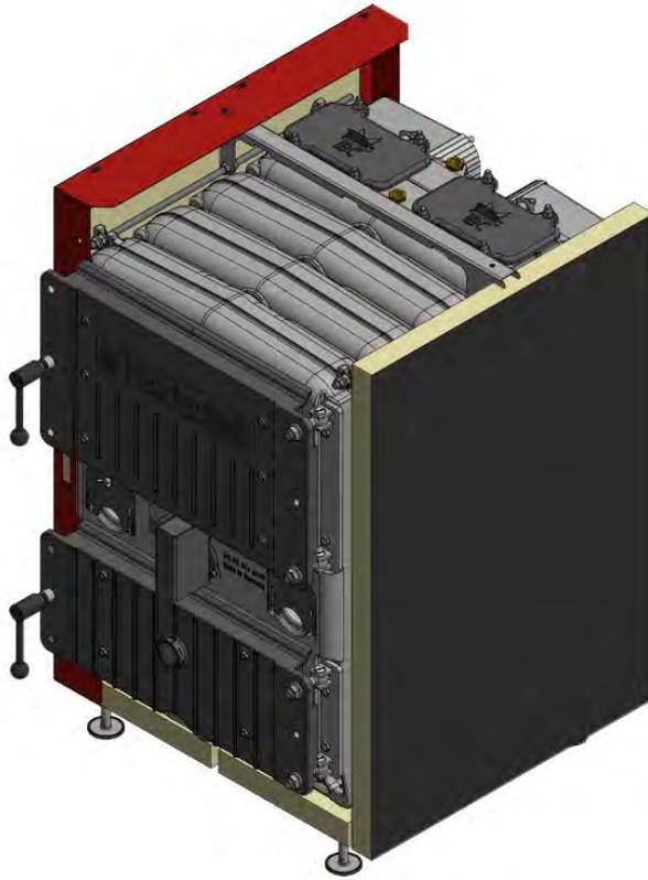
6. Nehmen Sie die rechte Seitenverkleidung und setzen Sie 4 Halteklammern für die Befestigung der Verkleidungsdeckel analog der linken Verkleidungsseite ein. Die Klammern müssen zur Montage zusammengedrückt und von unten in die Öffnungen gedrückt werden. Montieren Sie die Steckerleiste in den vorderen Ausschnitt Mittels 4 Stück Schrauben M5.
