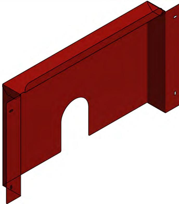
4. Schrauben Sie diese mit je zwei Schrauben M5 an die linke und rechte Seitenverkleidung.
