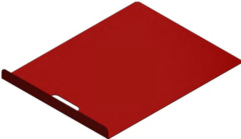
2. Sie benötigen eine Montagehilfe beispielsweise aus Karton Größe 500x500 mm, diesen können Sie aus dem Verpackungsmaterial ausschneiden. Die Montagehilfe dient dazu, die Dämmwolle anzuheben, so dass der Verkleidungsbogen problemlos eingeschoben werden kann.
