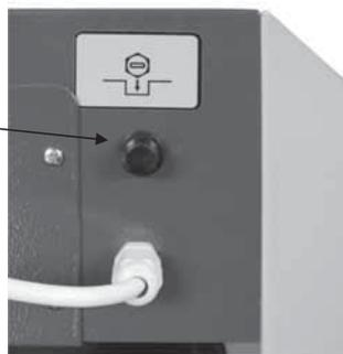
**Der Notfall-Thermostat ist auf der Hinterseite des Steuerschranks.**
